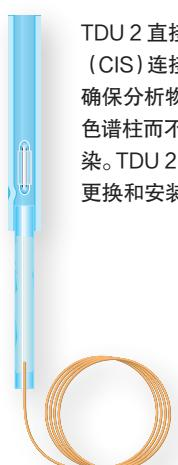
TDU 2 直接与大体积冷进样系统 (CIS) 连接：“管套管”的设计可确保分析物最大程度转移到 GC 色谱柱而不会发生歧视或交叉污染。TDU 2 对齐支撑杆简化了衬管更换和安装。
