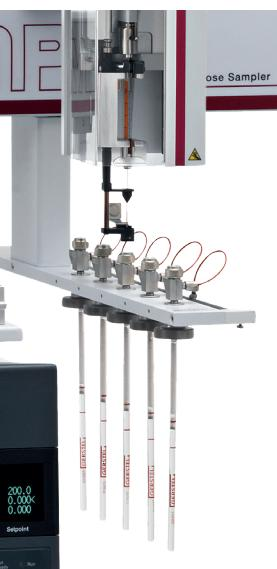
GERSTEL 的脱附管自动加标系统 TSS 可以自动制备热脱附管的标准分析管。根据标准方法, 通过 GERSTEL 的多功能进样器 MPS 在吸附管中加入用户自定义的一定量的标准溶液, 并用标准方法中所要求的校正和验证的载气流量吹扫去除溶剂。MPS 可安装多个 TSS 单元, 以实现更高的通量。
