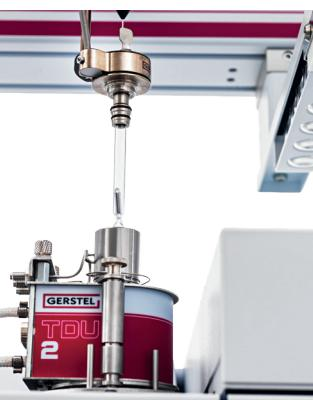
TDU 2 对放置在解吸管中的一个或多个 Twister 进行热解吸。使用 MPS 实现自动化，可以在一个序列中解吸多达 480 个 Twister。分析物被转移到 CIS 进行低温聚焦，随后以分流、不分流或多重解吸模式引入 GC-MS 色谱柱，涵盖广泛的浓度范围。
