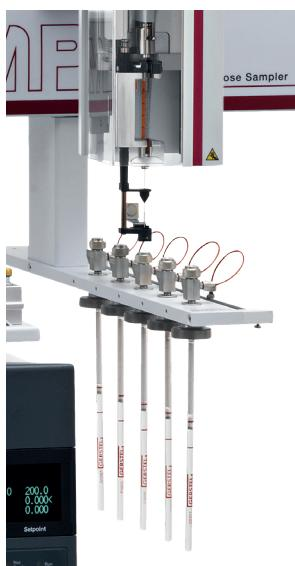
GERSTEL 的脱附管自动加标系统 TSS 可以自动制备热脱附管的标准分析管。根据标准方法，通过 GERSTEL 的多功能进样器 MPS 在吸附管中加入用户自定义的一定量的标准溶液，并用标准方法中所要求的校正和验证的载气流量吹扫去除溶剂。MPS 可安装多个 TSS 单元，以实现更高的通量。
