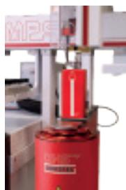
DHS 模块为各类型的样品提供了卓越的分析性能，如食品，饮料，聚合物，个人护理产品和药品包装。DHS Large 选项能够直接在1L容器中，分析体积较大的样品。
